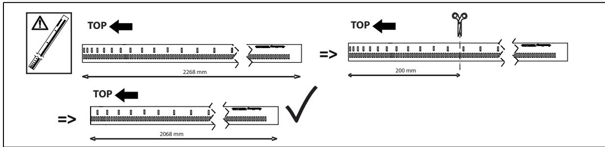
• Kurzes Säulenelement montieren • Install short column element • Monter l'élément court de la colonne
